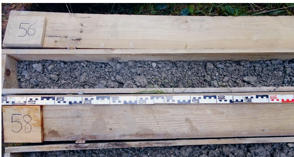
Kernbohrungen zur Untersuchung ausgelegt.
