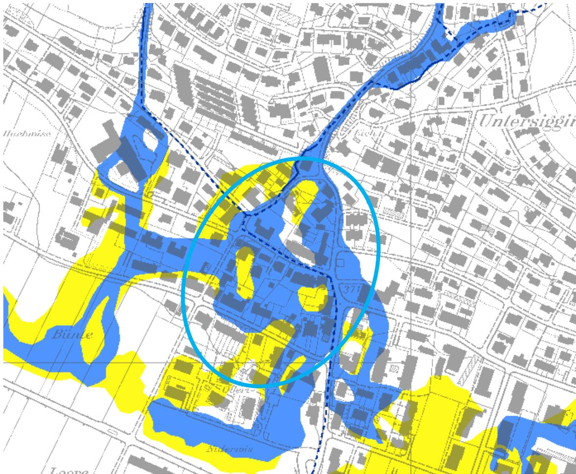
Ohne Umsetzung von Massnahmen kommt es zu erheblichen Überflutungen von Schächten (Node Flooding) und Überlastungen von Leitungen (Link Capacity > 1.0). Wie der untenstehenden Grafik entnommen werden kann, kommt es insgesamt an 15 Schächten zu Austritten mit bis zu ca. 790 l/s und acht Haltungen sind überlastet.
